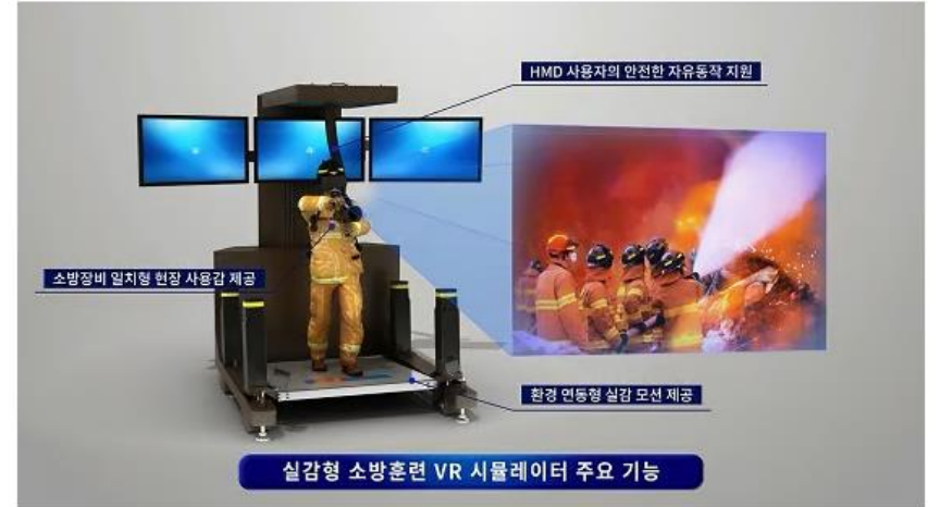
ETRI 연구진이 개발한 실감형 소방훈련 VR 시뮬레이터 주요 기능/사진=ETRI
